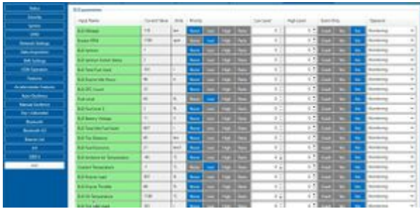
Example of J1939 parameters
