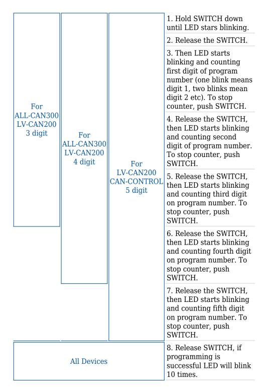
FMC125 CAN Adapter parameters configuration
